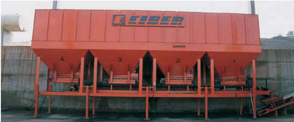
Conjunto de silos dosadores.
